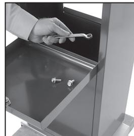
Spänn skruvarna och lägg tillbaka botten.
